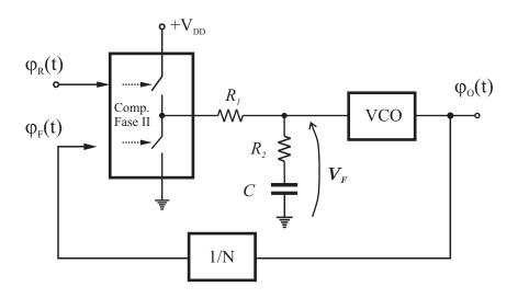
Si la señal  $\varphi_R(t)$  es una rampa de fase de pendiente variable  $F_{R\min} \leq \frac{\partial \varphi_R(t)}{\partial t} \leq F_{R\max}$ , dimensionar los componentes R<sub>1</sub>, R<sub>2</sub>, y C, y la constante  $K_{VCO}$ , en función del resto de los elementos del sistema para garantizar la estabilidad en el peor de los casos. Asumir  $F_{R\max} = 4F_{R\min}$  y dibujar un diagrama de Bode con la compensación propuesta.
