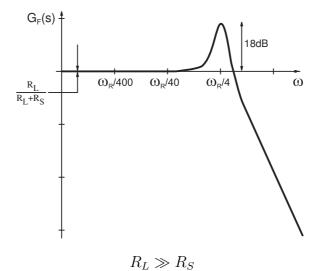
(a) Diseñe el controlador  $G_{C1}$  de forma tal de obtener el máximo ancho de banda del sistema y error nulo al escalón en regimen permanente. Elegir un margen de fase adecuado. Indique cual es ese ancho de banda
