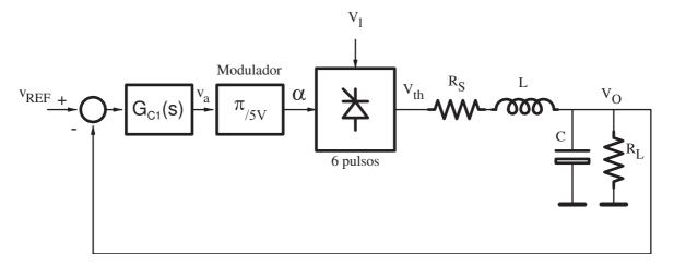
La transferencia  $G_F(s)$  entre la salida del puente a tiristores  $< V_{th}>$  y la tensión de salida  $< V_O>$  es como la mostrada en la figura
