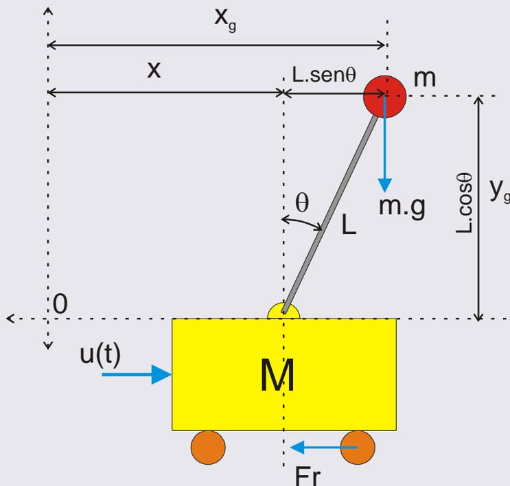
Se supone que la varilla no tiene masa, que la masa del carrito es  $M$  y la masa en el extremo superior del péndulo invertido es  $m$ . Hay una fuerza externa,  $u(t)$ , sobre el carrito en la dirección  $x$ , y una fuerza de gravedad que actúa sobre la masa del péndulo en todo momento.
