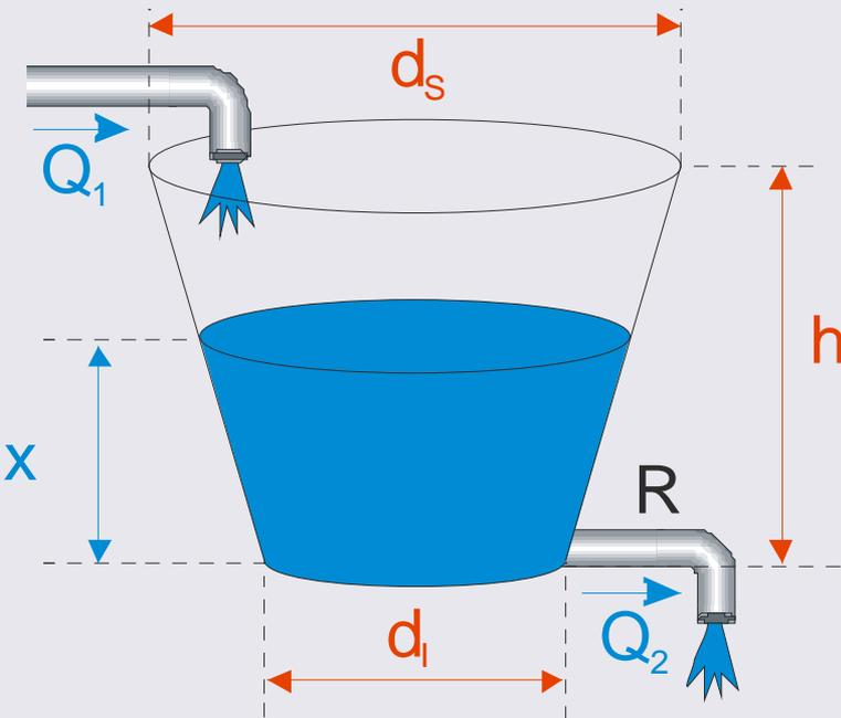
Supóngase, además que el sistema está ya operando en régimen permanente con un caudal de entrada constante. En estas condiciones se denominan  $Q_{10}$  y  $Q_{20}$  a los caudales de entrada y salida respectivamente y  $x_0$  la altura del líquido en el tanque. Obviamente es  $Q_{10} = Q_{20}$ .
