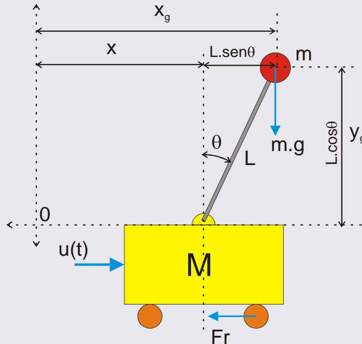
El centro de gravedad de la masa del péndulo viene dada por las coordenadas ,  $( x_g, y_g )$  donde  $L$  es la longitud de la varilla del péndulo.
