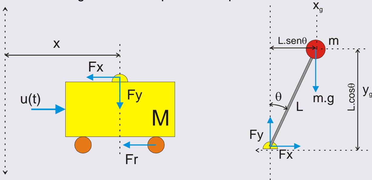
Aplicando la segunda ley de Newton para el movimiento del carro:
