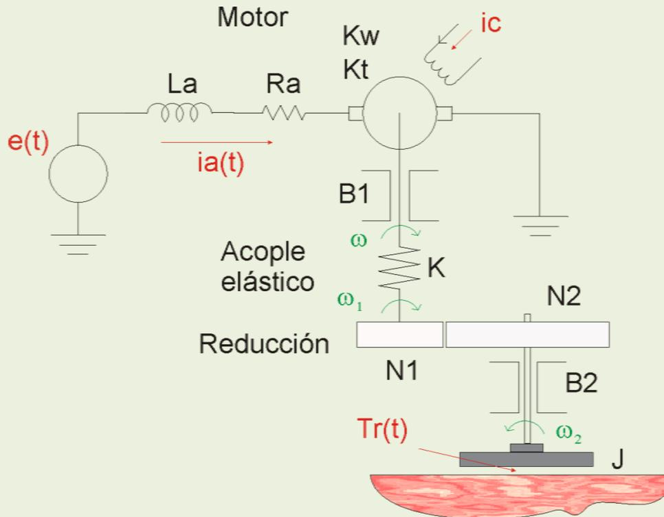
El motor posee un rozamiento en el eje de valor  $B1$ , la herramienta de pulido se acopla al motor a través de un acople elástico  $K$  y una reducción a engranajes cuya relación es  $N1/N2$ . La herramienta presenta un momento de inercia  $J$  y un rozamiento  $B2$ . El esfuerzo de pulido sobre la superficie es representado por una cupla resistente  $Tr$ .
