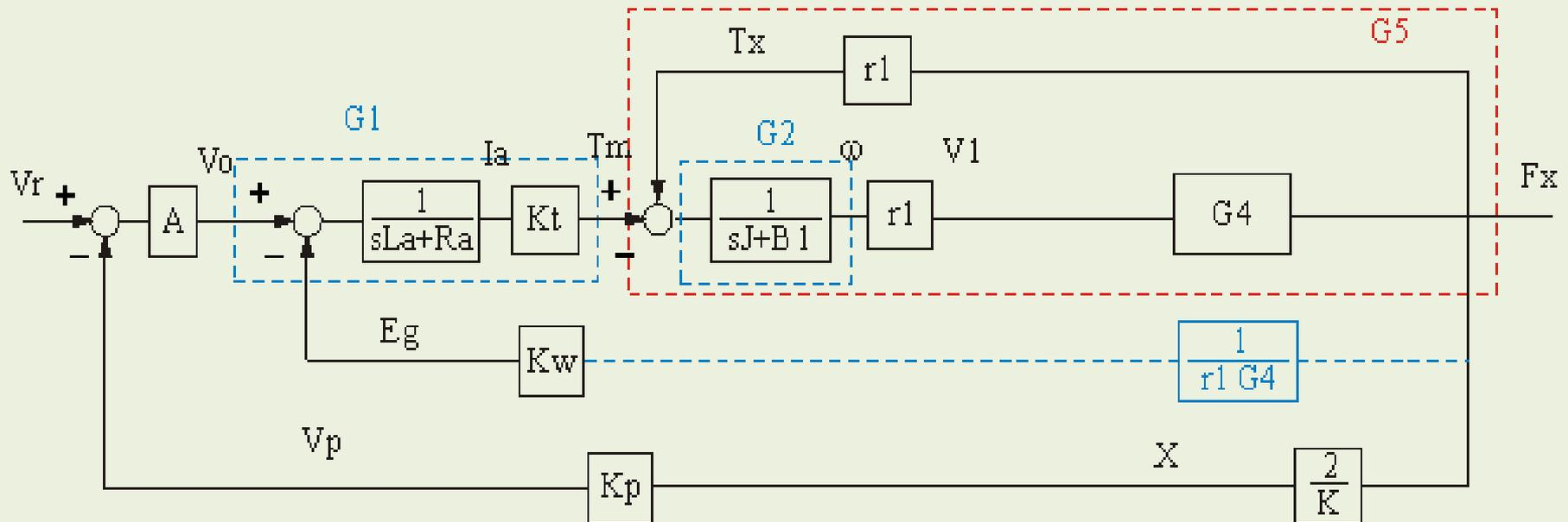
$$G_5 = \frac{G_4 G_2 r_1}{1 + G_4 G_2 r_1^2}$$
