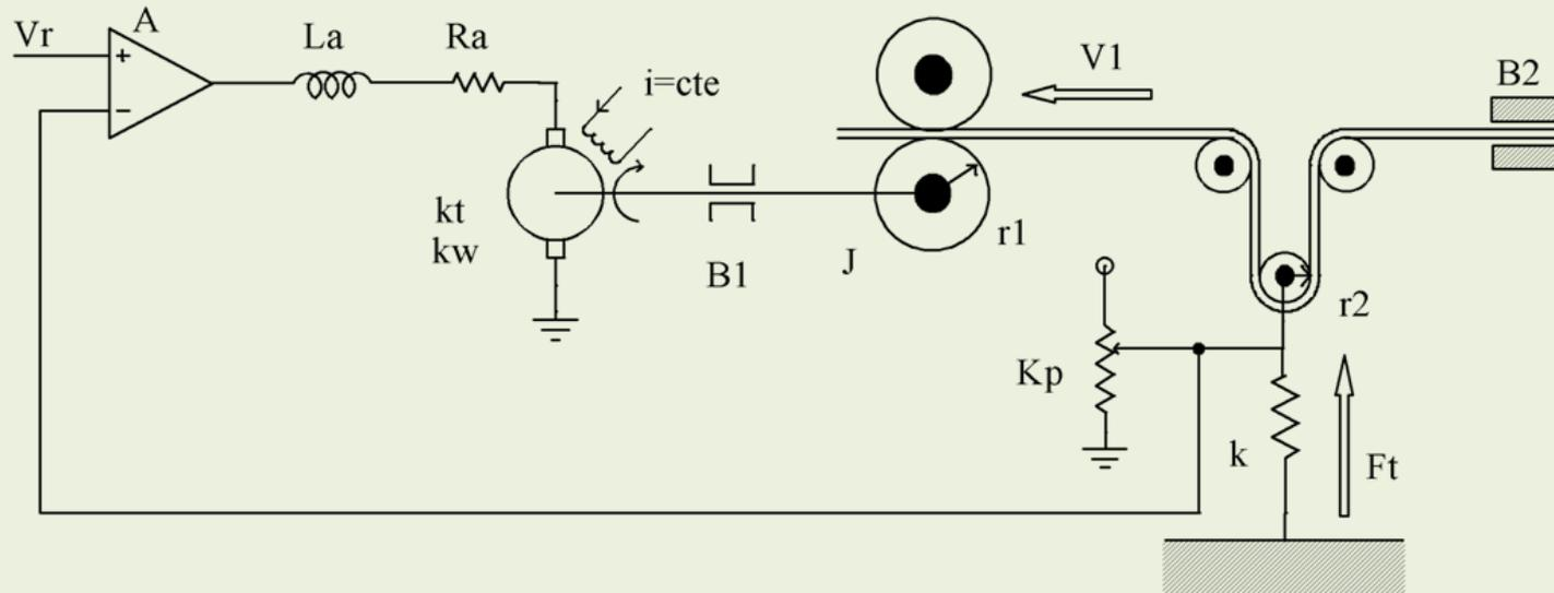
La lámina es traccionada sin deslizamiento por un rodillo. Este es movido por un motor de corriente continua controlado por armadura desde un amplificador de potencia. El arreglo de rodillos y polea ubicados en la parte derecha de la figura produce una fuerza  $F_t$  proporcional a la tensión de la lámina.
