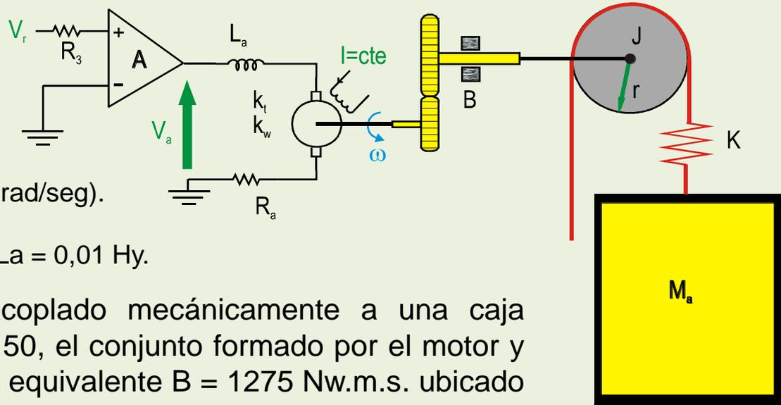
El eje del motor se encuentra acoplado mecánicamente a una caja reductora cuya relación es  $N_2/N_1 = 50$ , el conjunto formado por el motor y la reducción presenta un rozamiento equivalente  $B = 1275$  Nw.m.s. ubicado a la salida del mismo.
