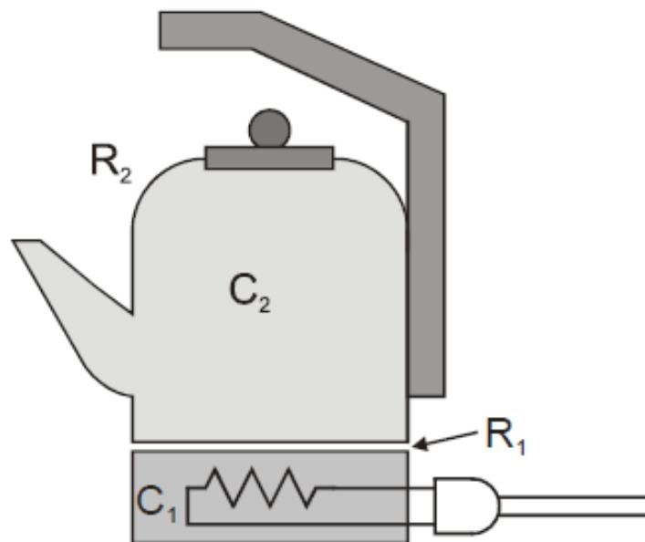
La placa se encuentra en contacto con el elemento líquido , en esta interfase se produce una caída de temperatura que se puede concentrar en una resistencia térmica de valor  $0.83333 \text{ } ^{\circ}\text{C/Watt}$  . El volumen del líquido es de aproximadamente de 1 litro lo que origina que este elemento posea una capacidad térmica de 4000 Joule/ $^{\circ}\text{C}$ .
