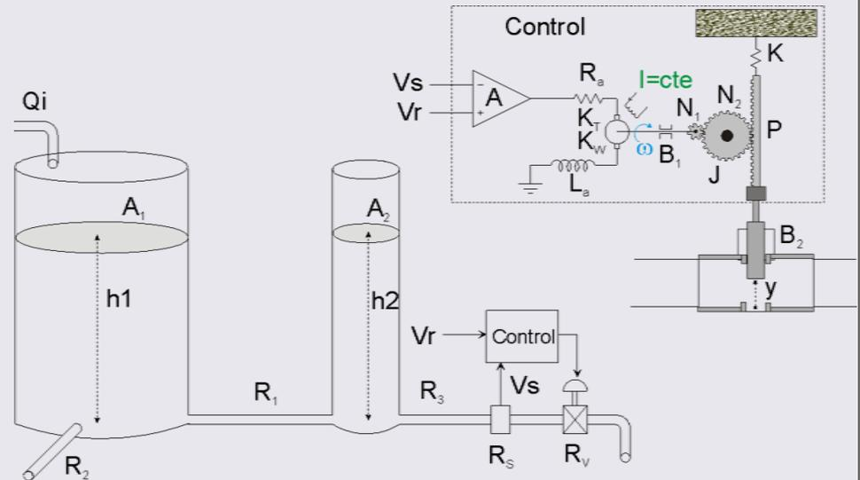
Desde el tanque de área  $A_1$  se deriva una tubería de resistencia hidráulica  $R_1$  por donde circula el caudal hacia el otro tanque y una tubería destinada a otro proceso cuyo caudal está determinando por la resistencia  $R_2$ .
