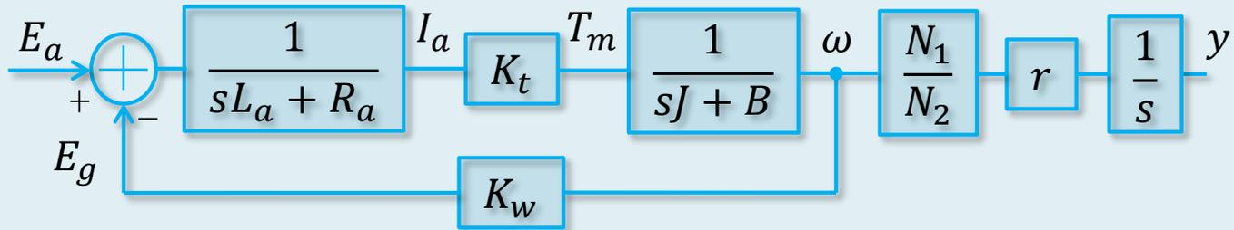
$$\begin{bmatrix} \dot{I}_a \\ \dot{\omega} \\ \dot{y} \end{bmatrix} = \begin{bmatrix} -\frac{R_a}{L_a} & -\frac{K_w}{L_a} & 0 \\ \frac{K_t}{J} & -\frac{B}{J} & 0 \\ 0 & N & 0 \end{bmatrix} \begin{bmatrix} I_a \\ \omega \\ y \end{bmatrix} + \begin{bmatrix} \frac{1}{L_a} \\ 0 \\ 0 \end{bmatrix} E = \begin{bmatrix} -160 & -226,667 & 0 \\ 22,667 & -0,03667 & 0 \\ 0 & 0,1 & 0 \end{bmatrix} \begin{bmatrix} I_a \\ \omega \\ y \end{bmatrix} + \begin{bmatrix} 333,33 \\ 0 \\ 0 \end{bmatrix} E$$
