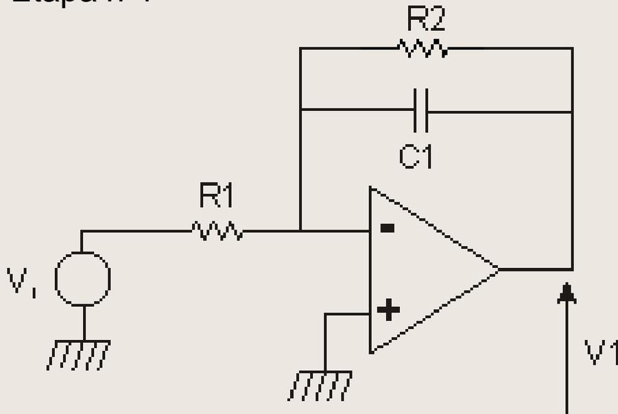
$$\begin{bmatrix} \dot{X}_1 \end{bmatrix} = \begin{bmatrix} -\frac{1}{C_1 R_2} \end{bmatrix} \cdot \begin{bmatrix} X_1 \end{bmatrix} + \begin{bmatrix} \frac{1}{C_1 R_1} \end{bmatrix} V_i$$
