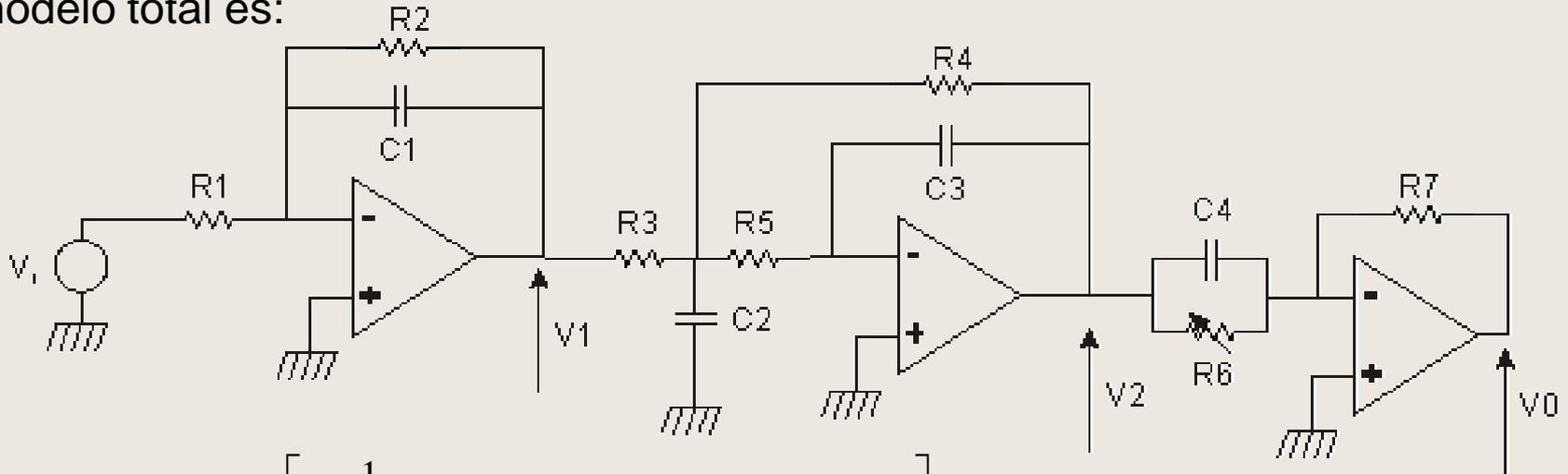
$$\begin{bmatrix} \dot{X}_1 \\ \dot{X}_2 \\ \dot{X}_3 \end{bmatrix} = \begin{bmatrix} -\frac{1}{C_1 R_2} & 0 & 0 \\ -\frac{1}{C_2 R_3} & -\frac{1}{C_2 R_3} \left( 1 + \frac{R_3}{R_5} + \frac{R_3}{R_4} \right) & -\frac{1}{C_2 R_4} \\ 0 & \frac{1}{C_3 R_5} & 0 \end{bmatrix} \cdot \begin{bmatrix} X_1 \\ X_2 \\ X_3 \end{bmatrix} + \begin{bmatrix} \frac{1}{C_1 R_1} \\ 0 \\ 0 \end{bmatrix} V_i$$
