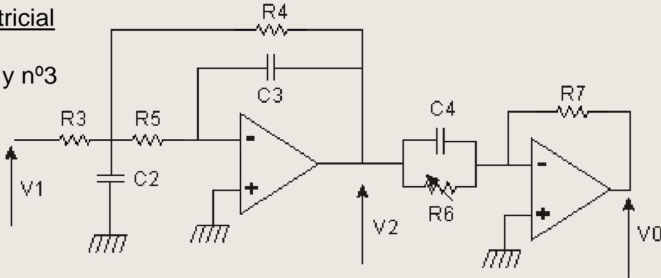
$$\begin{bmatrix} \dot{X}_2 \\ \dot{X}_3 \end{bmatrix} = \begin{bmatrix} -\frac{1}{C_2 R_3} \left( 1 + \frac{R_3}{R_5} + \frac{R_3}{R_4} \right) & -\frac{1}{C_2 R_4} \\ \frac{1}{C_3 R_5} & 0 \end{bmatrix} \cdot \begin{bmatrix} X_2 \\ X_3 \end{bmatrix} + \begin{bmatrix} \frac{1}{C_2 R_3} \\ 0 \end{bmatrix} V_i \quad V_2 = \begin{bmatrix} \frac{C_4 R_7}{C_3 R_5} & \frac{R_7}{R_6} \end{bmatrix}$$
