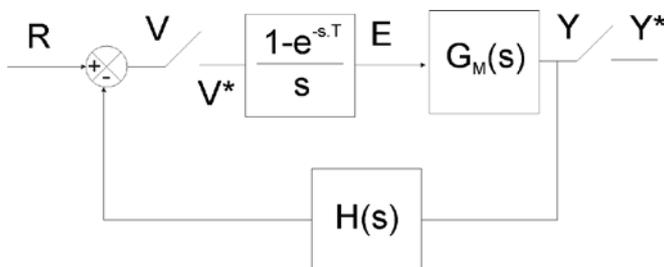
$$\text{A partir del diagrama en bloques se calcula la transferencia discreta a lazo cerrado: } T(z) = \frac{Y(z)}{R(z)} = \frac{G(z)}{1+GH(z)}$$
