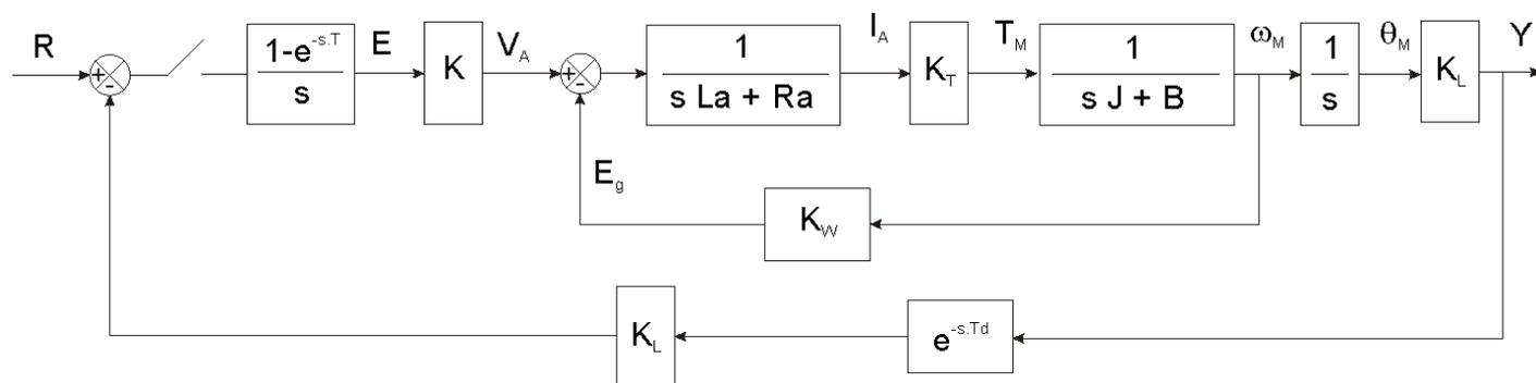
Como el sistema tiene un muestreador se debe analizar a partir de la transformada Z.
