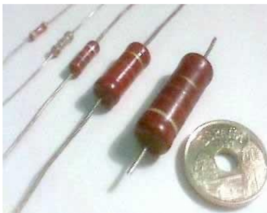
Figura 5. Diferentes valores de resistencia de película, de izquierda a derecha 1/8, 1/4, 1/2, 1 y 2 W.
