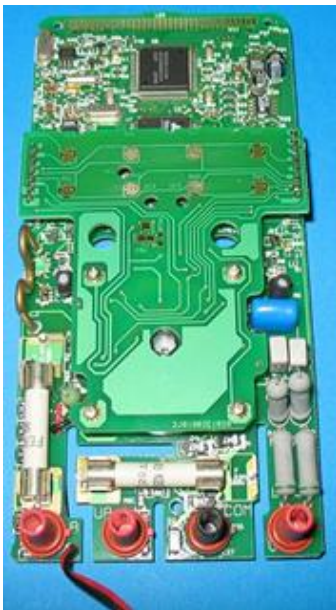
Fusibles en placa de multímetro comercial
