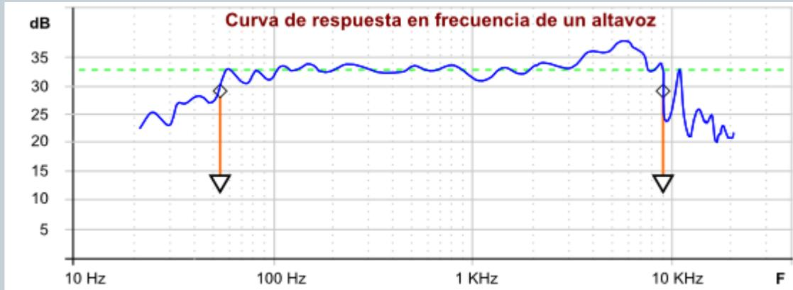
La forma en que un circuito responde al variar la frecuencia de alimentación es llamada “respuesta en frecuencia” del circuito
