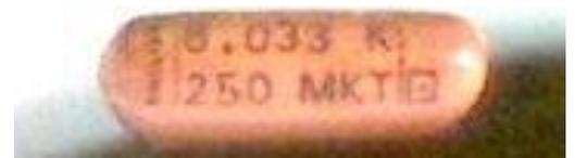
4. De **poliéster**. Son similares a los anteriores, aunque con un proceso de fabricación algo diferente. En ocasiones este tipo de condensadores se presentan en forma plana y llevan sus datos impresos en forma de bandas de color, recibiendo comúnmente el nombre de condensadores "de bandera". Su capacidad suele ser como máximo de  $470 \text{ nF}$ .
