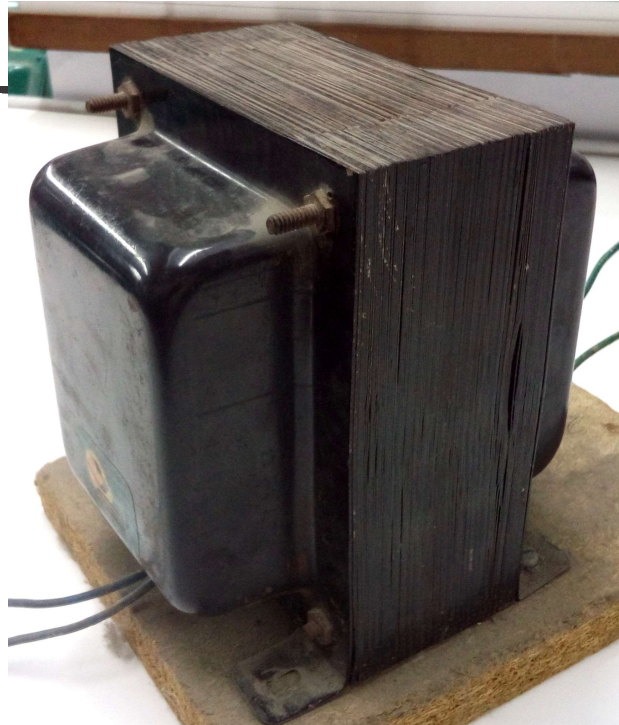
TRAFO 1 Alto = 150 mm Ancho = 125 mm Apilado = 60 mm
