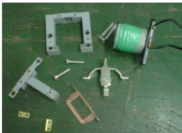
Figura 62 – Detalle del transformador de medida construido
