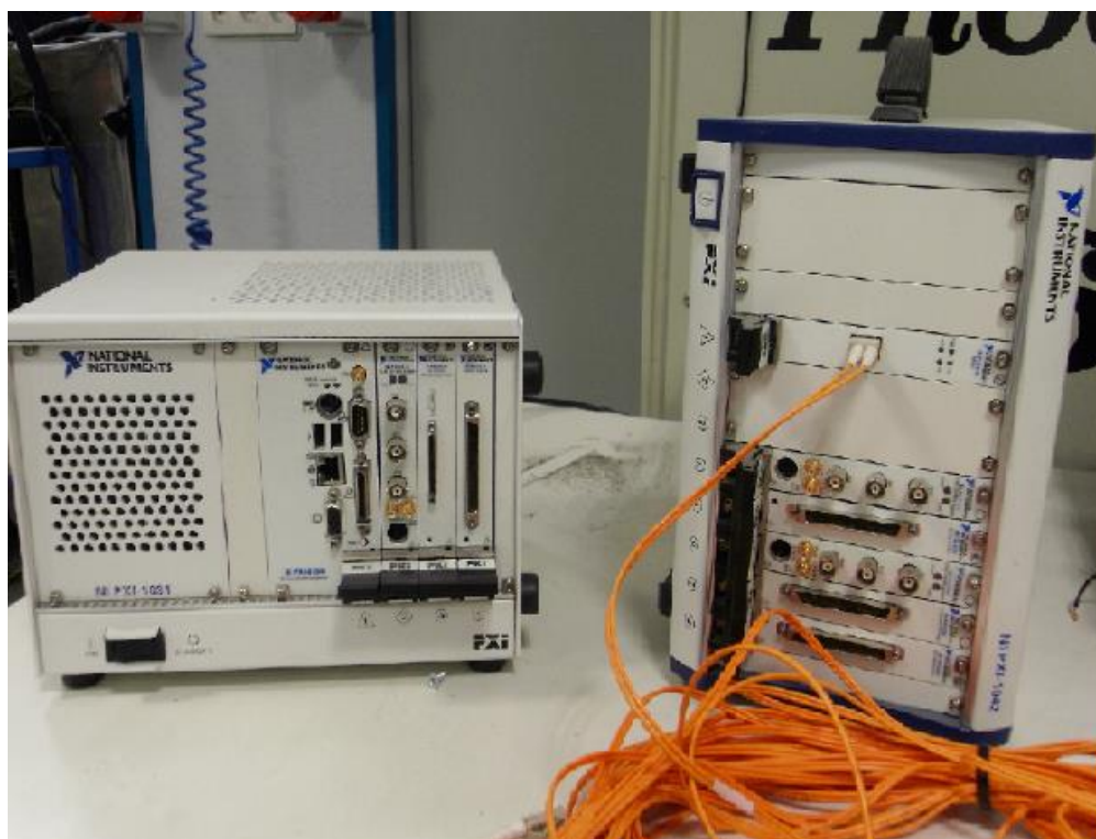
Figura 45 – Equipamiento PXI- MXI-4 y PXI-RT de MGEP para Media Tensión.
