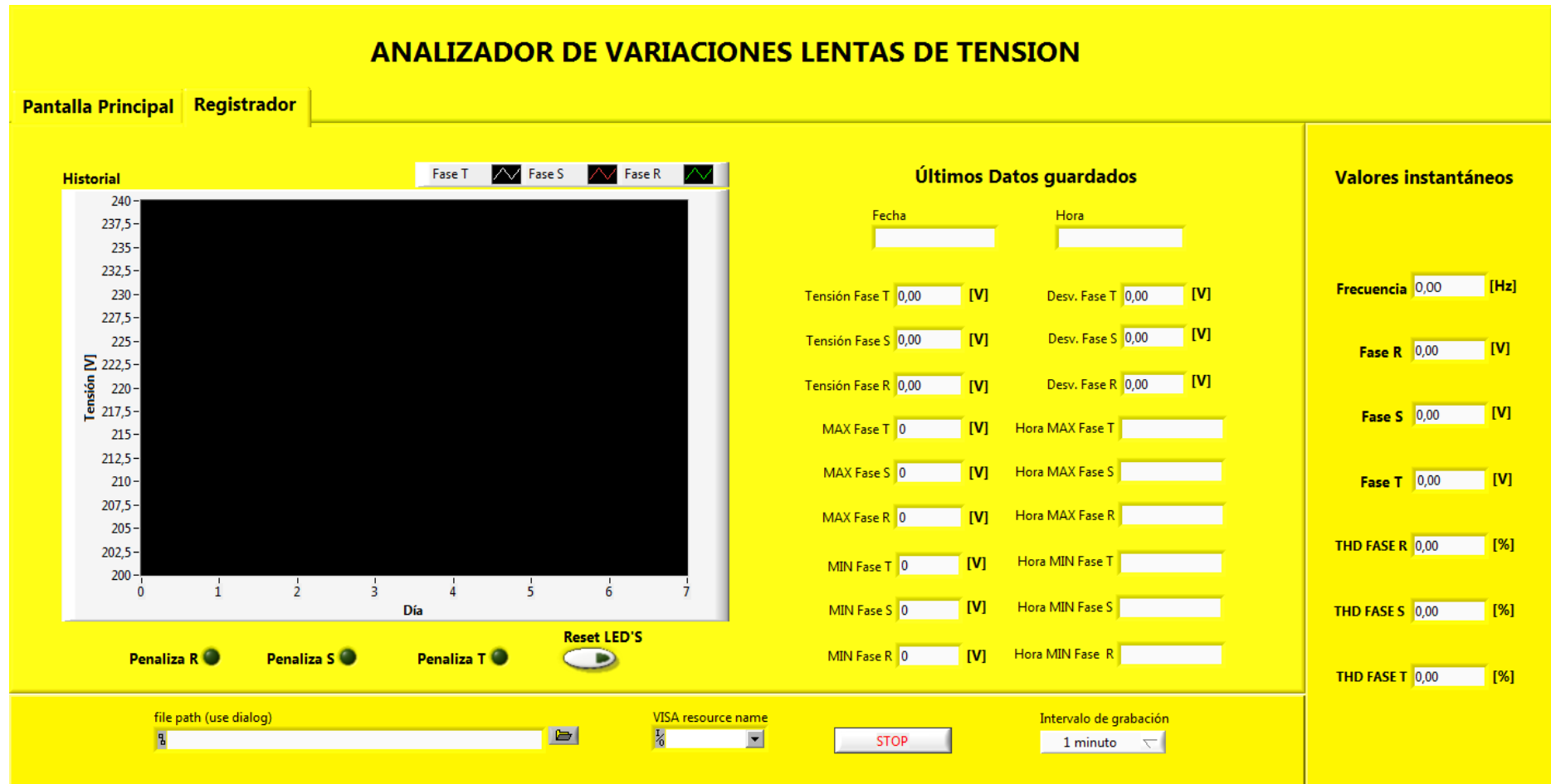
Figura 81 – Panel frontal del Analizador de Variaciones Lentas de Tensión en la pestaña “Registrador”
