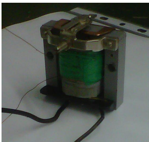
Figura 62 – Detalle del transformador de medida construido
