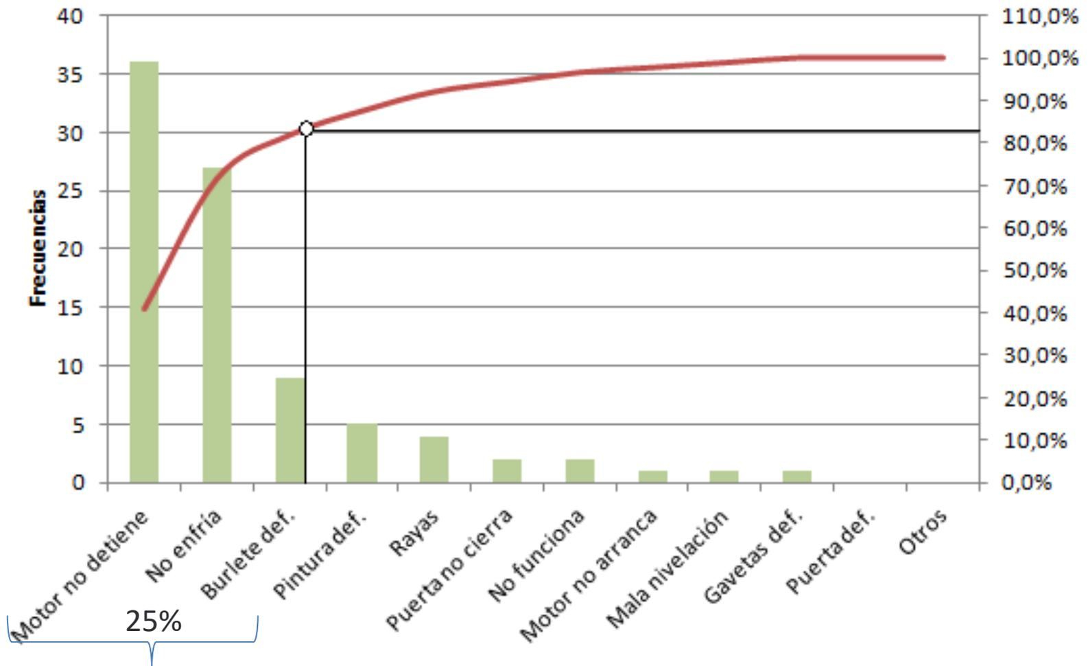
En éste caso el 81,8% de los defectos del proceso corresponden al 25% de los tipos de defectos, es decir que tan solo solucionando las 3 principales inconformidades se solucionarían el 81,8% de unidades defectuosas.
