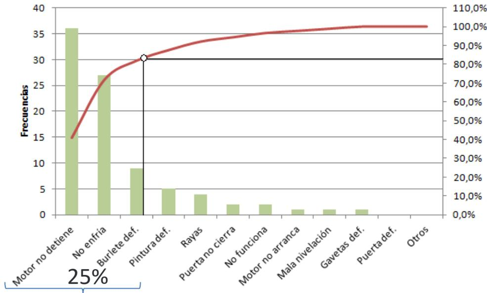
En éste caso el 81,8% de las consecuencias (defectos del proceso) corresponden al 25% de las causas (los tipos de defectos), es decir que tan solo solucionando las 3 principales inconformidades se solucionarían el 81,8% de unidades defectuosas.
