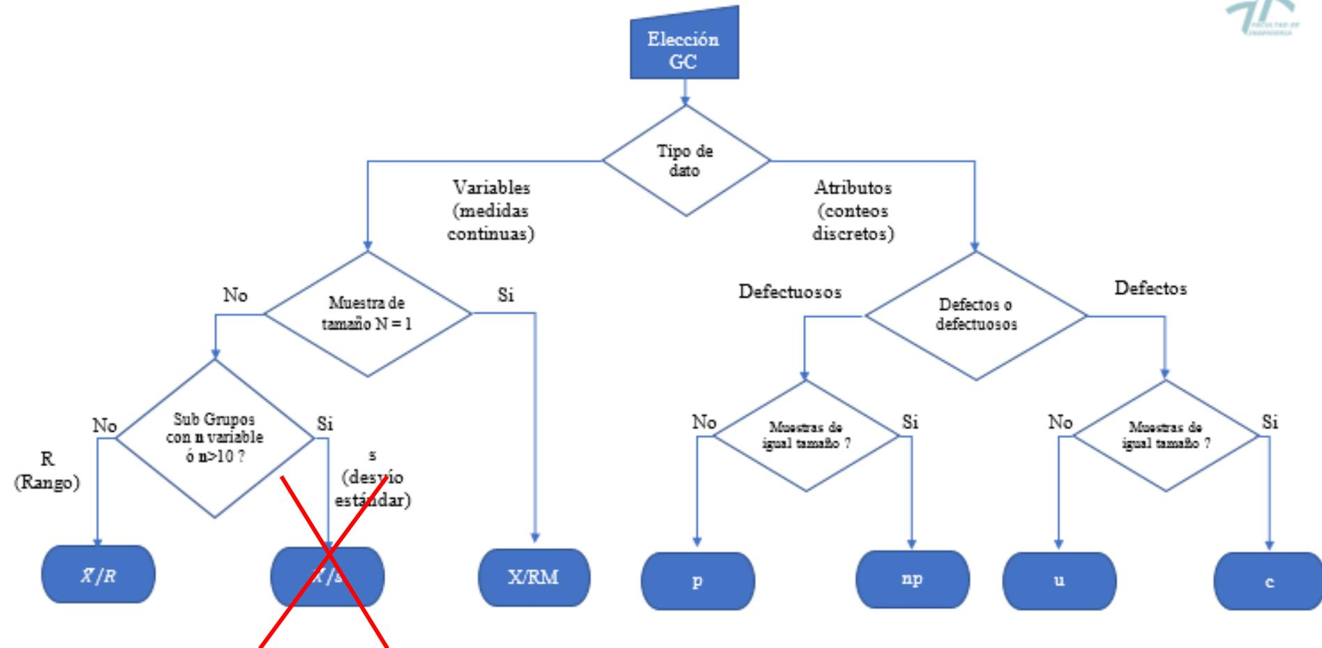
**Nota1:** Se suele usar un GC del tipo X/RM cuando la única muestra de tamaño N=1 tiene entre 15 y 25 datos
