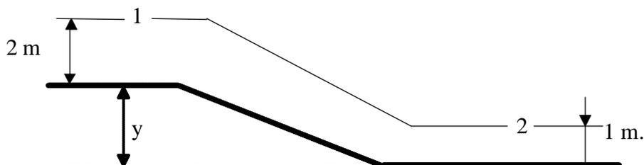
10. Desde el tanque rectangular de dimensiones 2.6 x 9.5 metros mostrado en la figura fluye agua hacia un manómetro. La salida del tanque tiene un diámetro de 0.02 metros. Asuma flujo cuasiestático. Note que el área del tanque es muy grande con
