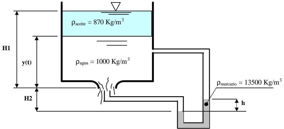
11. Calcule la lectura del manómetro,  $h$ , para el dispositivo mostrado en la figura.
