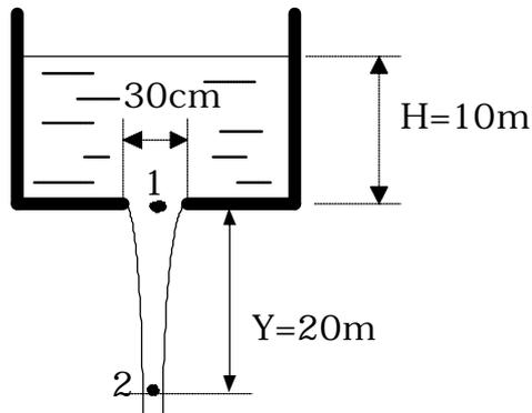
14. Dado el esquema de la figura, calcular la línea de energía total y la piezométrica. Se desprecian las pérdidas.
