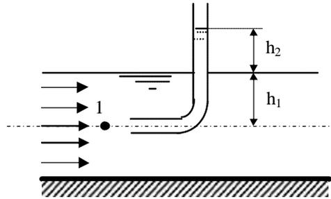
8. El dispositivo esquematizado en la figura se emplea para determinar la velocidad del fluido en una tubería. Exprese la velocidad del fluido en función de la diferencia de niveles  $h$  y las densidades relativas de los líquidos.
