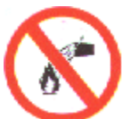
Prohibido apagar con agua
