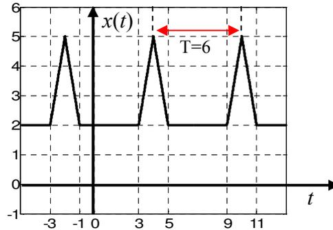
Consideremos la señal  $v(t)=x(t-2)-2$ , que es una señal que se obtiene desplazando a  $x(t)$  “para abajo”, es decir, restando 2 en amplitud a toda la señal, con lo que queda:
